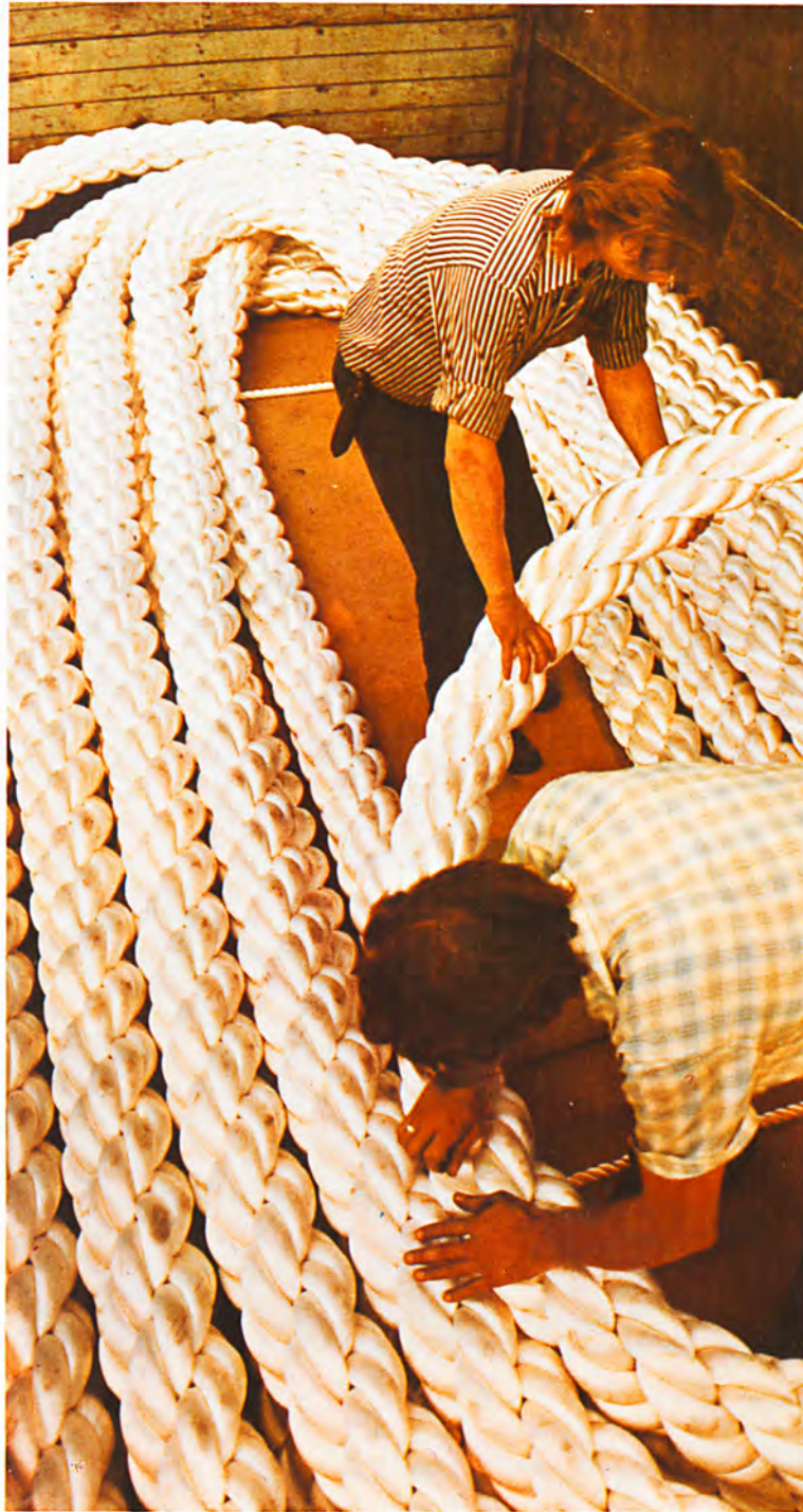
Ein 18-Zoll-Kabel wird verladen – harte Arbeit An 18 in. cable laid rope being loaded – hard work
