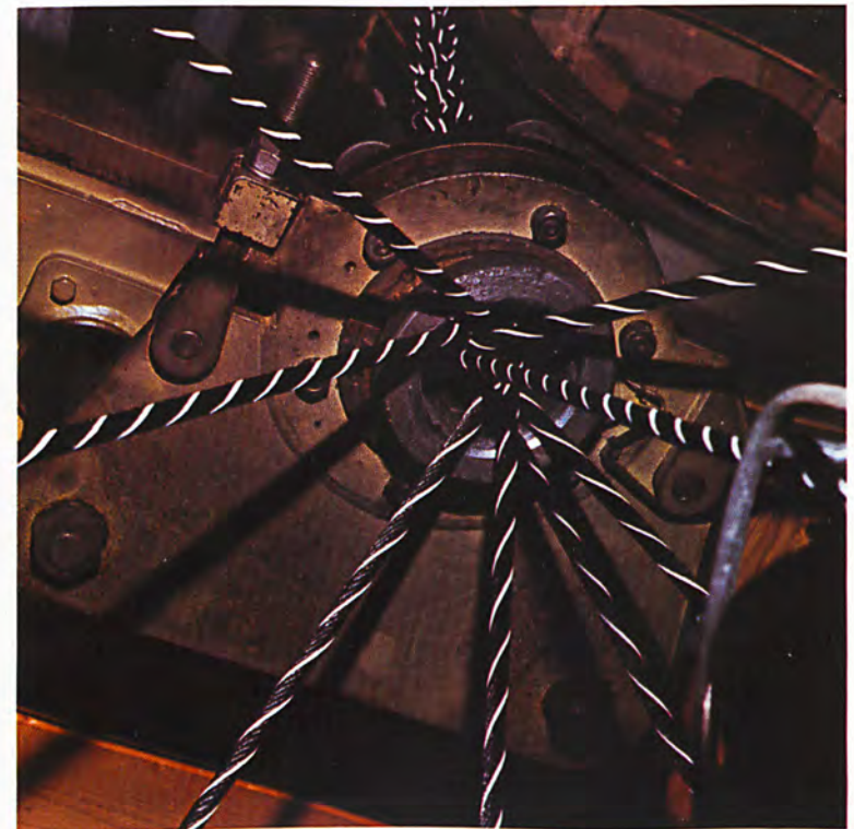
Acht Litzen im Flechtkopf Eight strands in the braiding head
