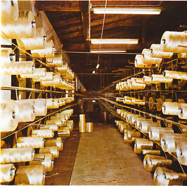
Seilzwirne im Ablaufrahmen der Bahn
