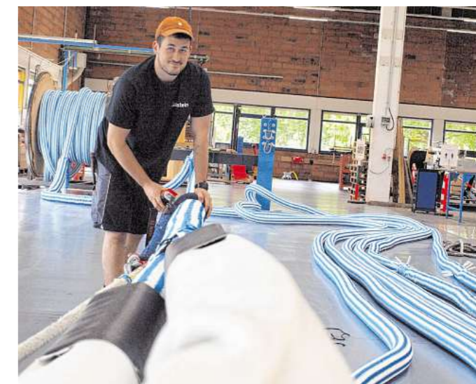
Der Beruf des Seilers erfordert noch Muskelkraft. Fürs Foto schiebt Hendrik Borchardt den Mantel auf das Auge des Seils. Die Fachleute sprechen von „melken“.
